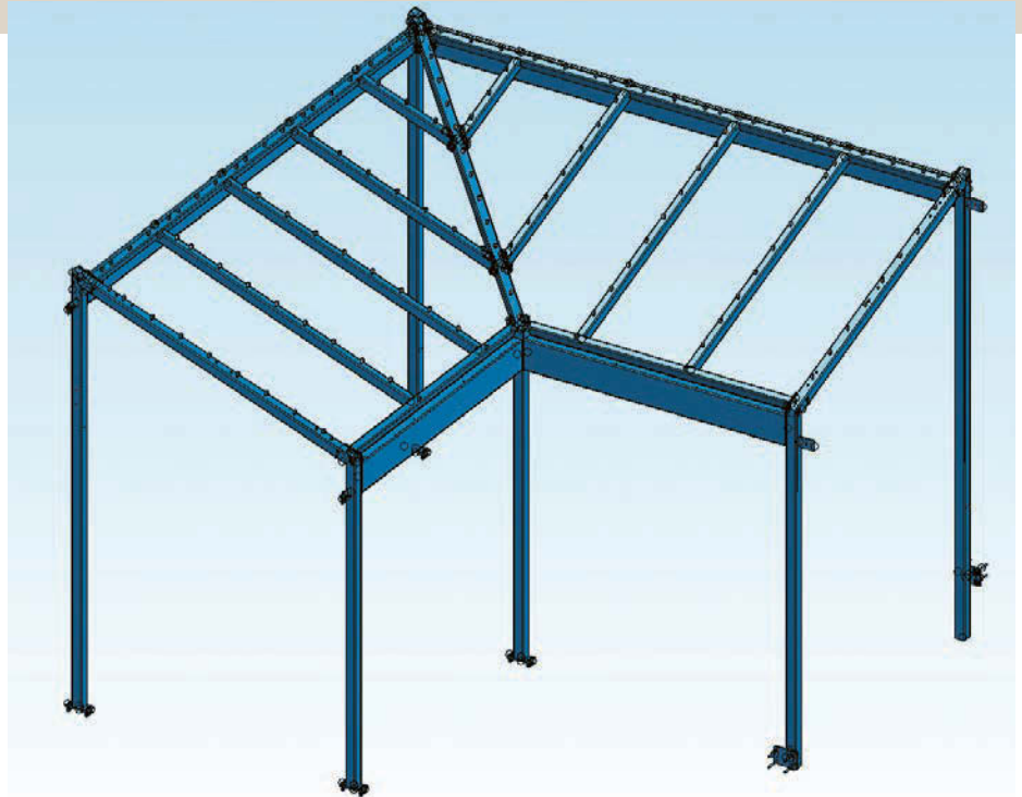
3D-Ansicht eines Eckelements der Überdachung Surseepark. Erst nach der Detailgenehmigung wurde mit dem Konstruieren des 3D-Modells angefangen.
