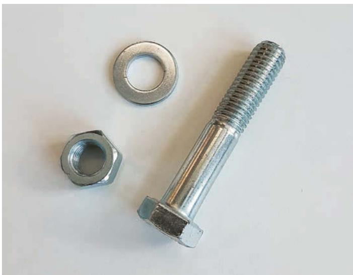
Abbildung b: Optisches Erscheinungsbild von verzinkt blau passivierten Verbindungselementen. Das typische Aussehen geht von klar bis bläulich, wobei bläulich von hellblau bis dunkelblau irisierend variieren kann.
