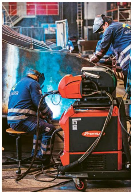
Damit sich die Teile präzise montieren lassen, müssen Schweißer eine Toleranzvorgabe im Millimeterbereich einhalten.
