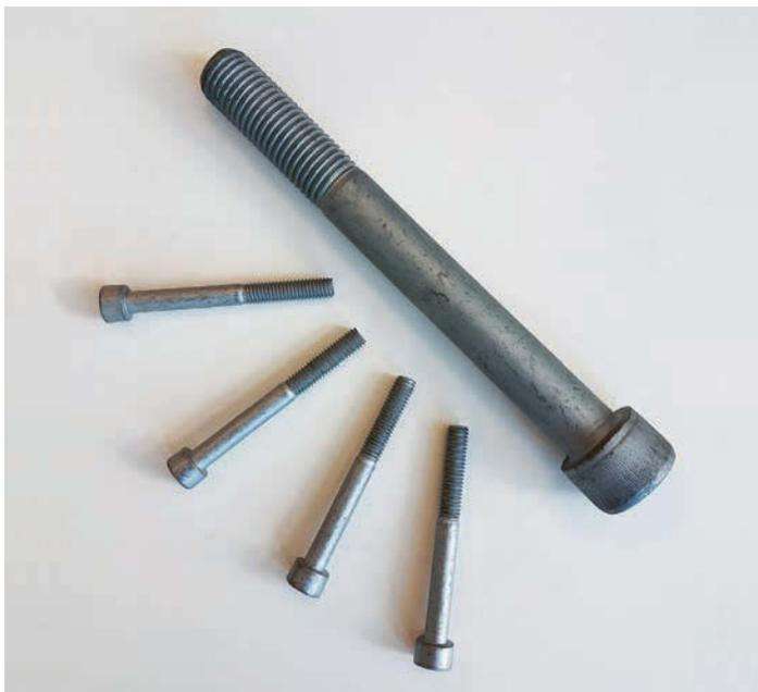
Figure e : Revêtement de zinc lamellaire sur des vis standard. Utilisation : les systèmes de zinc lamellaire sont mieux protégés contre la corrosion que des vis à zingage galvanique. Toutefois, ils sont prévus exclusivement pour l'intérieur. Il faut éviter l'exposition directe aux intempéries.
