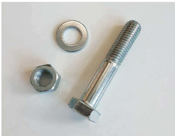
Illustration b : Aspect d'éléments d'assemblage zingués passivés bleu. L'apparence typique va de clair à bleuâtre, le bleuâtre pouvant varier d'une irisation bleu clair à bleu sombre. Utilisation : les vis à zingage galvanique passivées bleu ne sont prévues que pour l'intérieur. Il faut éviter l'exposition directe aux intempéries.
