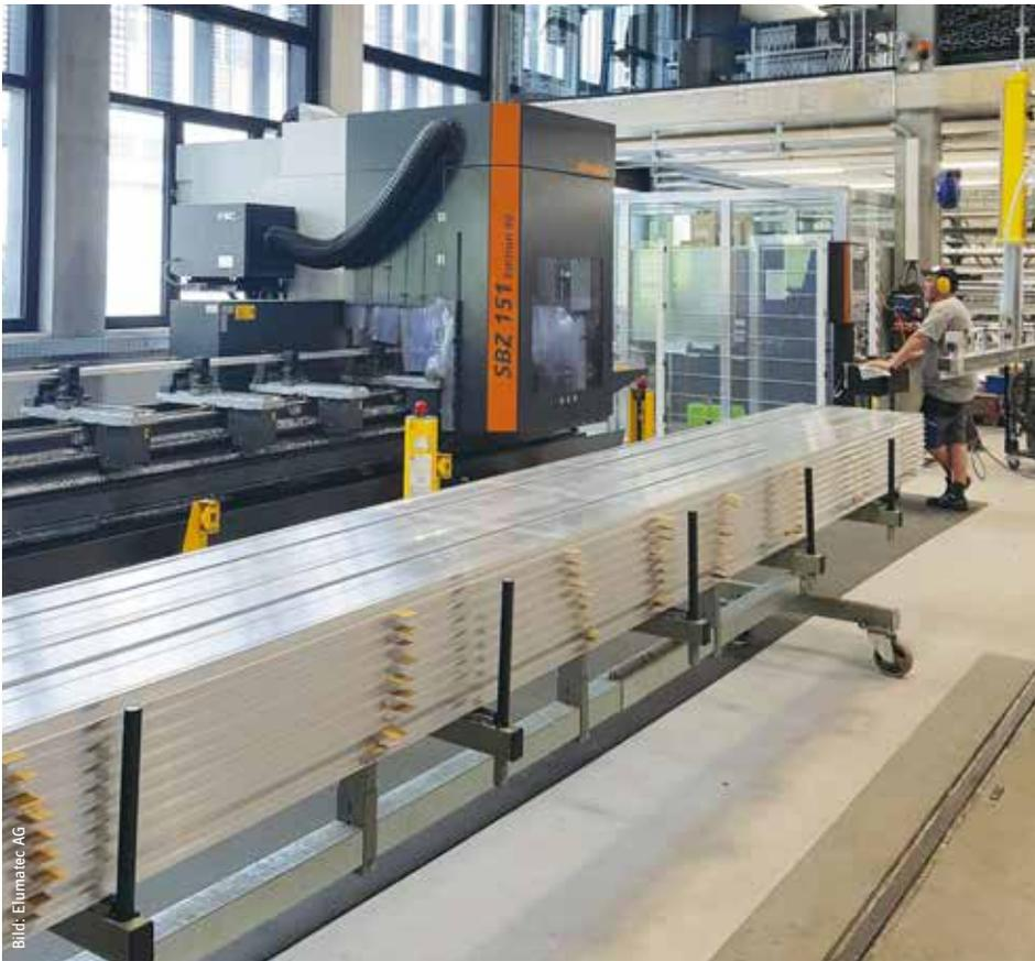
Das Stabbearbeitungszentrum SBZ 151 Edition 90 wird für Balkone, Ganzglasgeländer und Profilsysteme verwendet.
