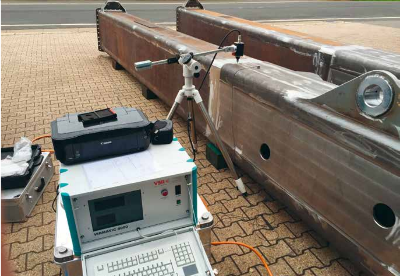
Die präzise Modalanalyse liefert die werkstückrelevanten Daten. L'analyse modale précise fournit des données importantes sur la pièce.
