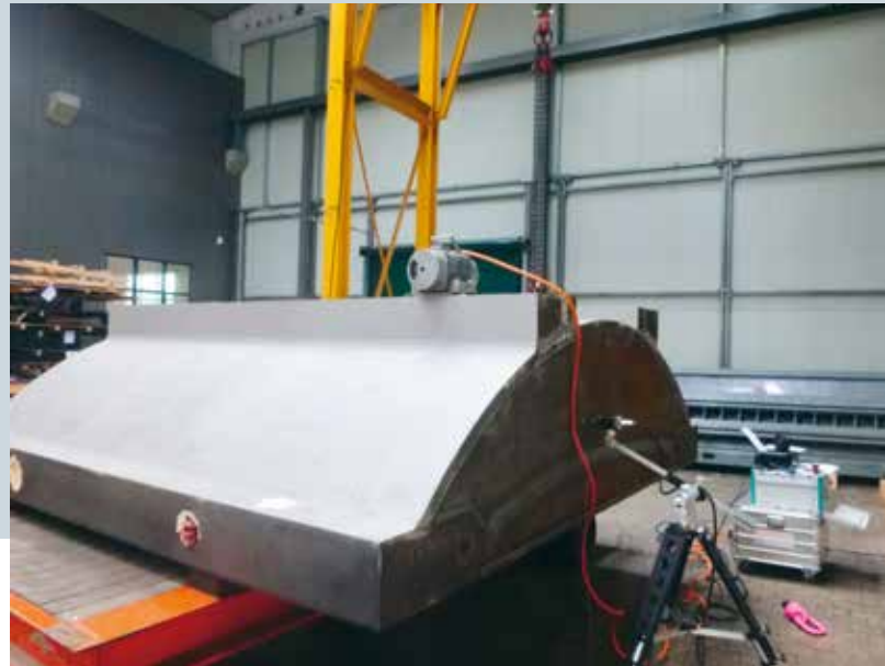
Das Vibrieren ist auch für Blechkonstruktionen oder Behälter bestens geeignet. Les vibrations sont parfaitement adaptées aux tôles et aux réservoirs.
