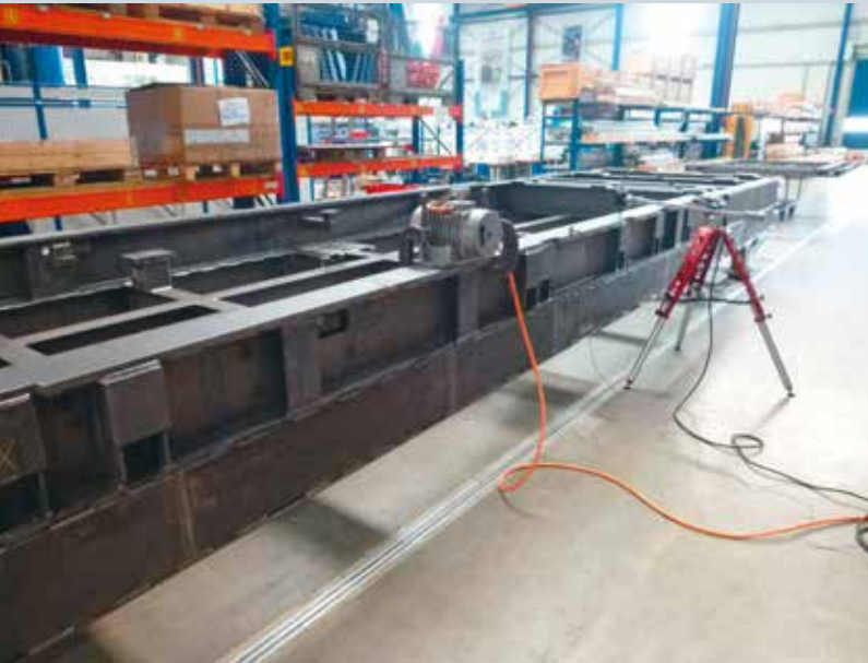
Das Vibrieren am mehrfach geschweißten Stahlträger löst Eigenspannungen. Les vibrations sur le support métallique soudé plusieurs fois atténuent les tensions internes.
