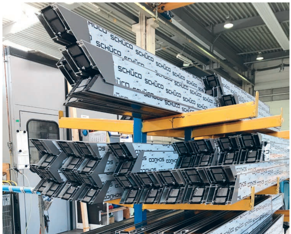
Bereitstellung des Materials für die Elementfertigung mit den Packlisten aus E-R-Plus.
