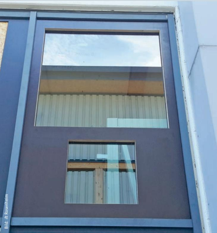
In-situ-Test von Vakuum-Isolierglas nach Prüfprogramm des ift-Hausverfahrens.
