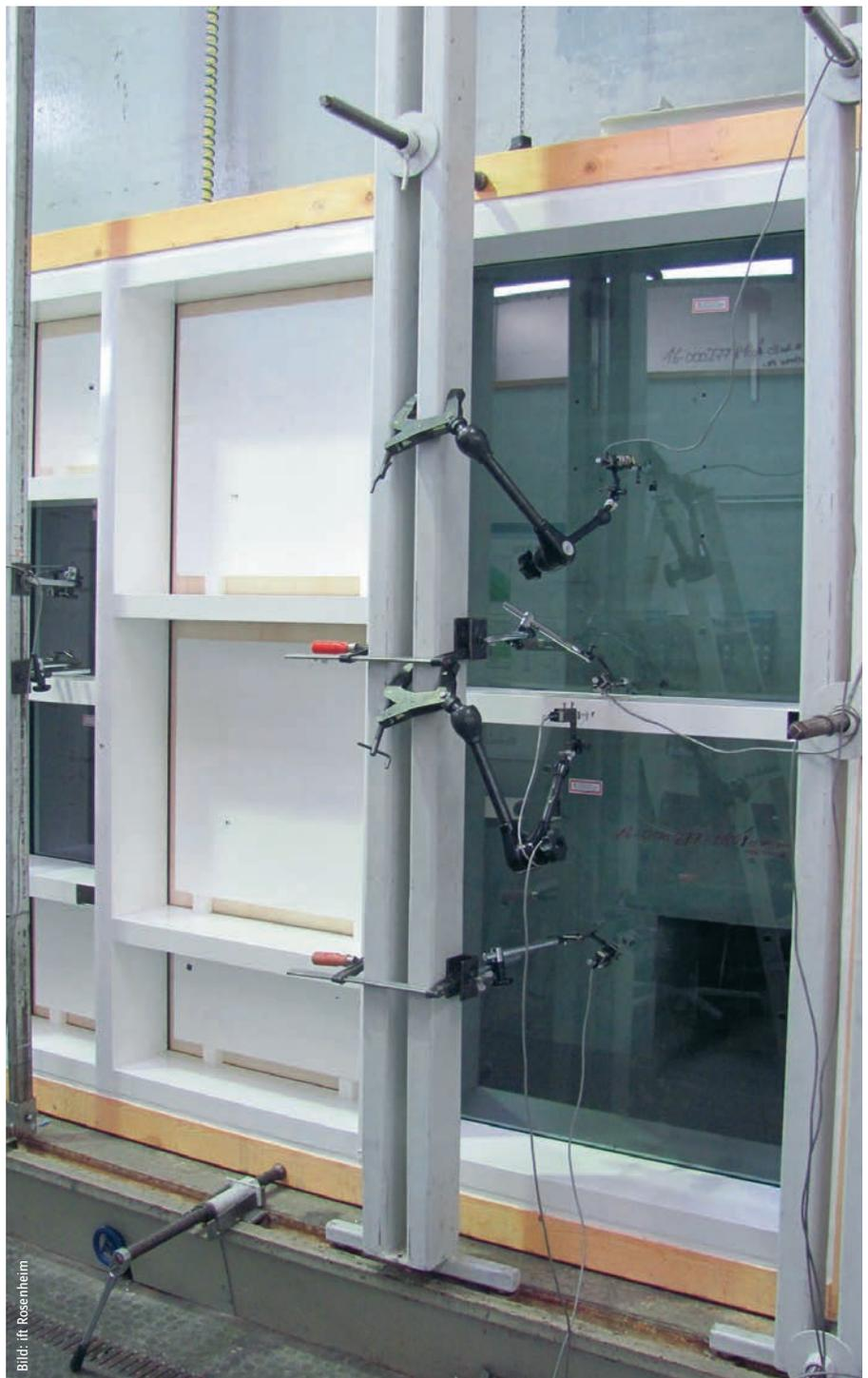
Prüfung von Vakuum-Isolierglas nach ift-Hausverfahren: Künstliche Alterung durch mechanische Belastung.
