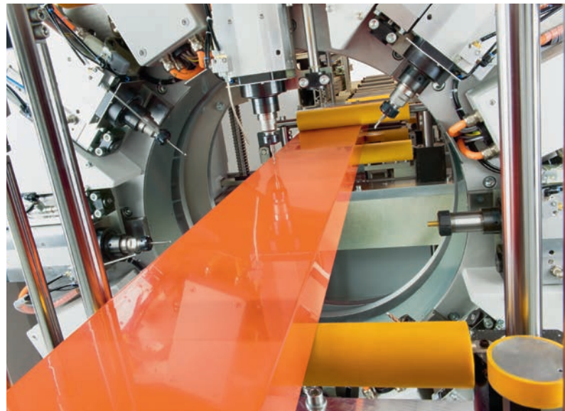
Für mehr Flexibilität: Im Bearbeitungsmodul können durch die vier einsetzbaren Frässpindeln Profile unter jedem beliebigen Winkel zwischen 0 und 360° bearbeitet werden.
