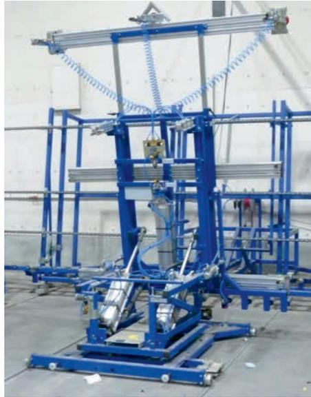
Die dreh-, schwenk- und fahrbaren Arbeitstische erleichtern den Zusammenbau der Elemente sowie die innerbetriebliche Logistik.
