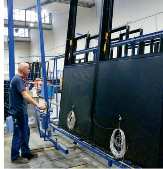
Die auf Rollenbahnen gelagerten Fassadenelemente werden im Werk mit schaltbarem Glas und Solarpanels bestückt, bevor sie mit dem multiflexiblen Hebe- und Transportsystem auf die Transportböcke gehievt werden.
