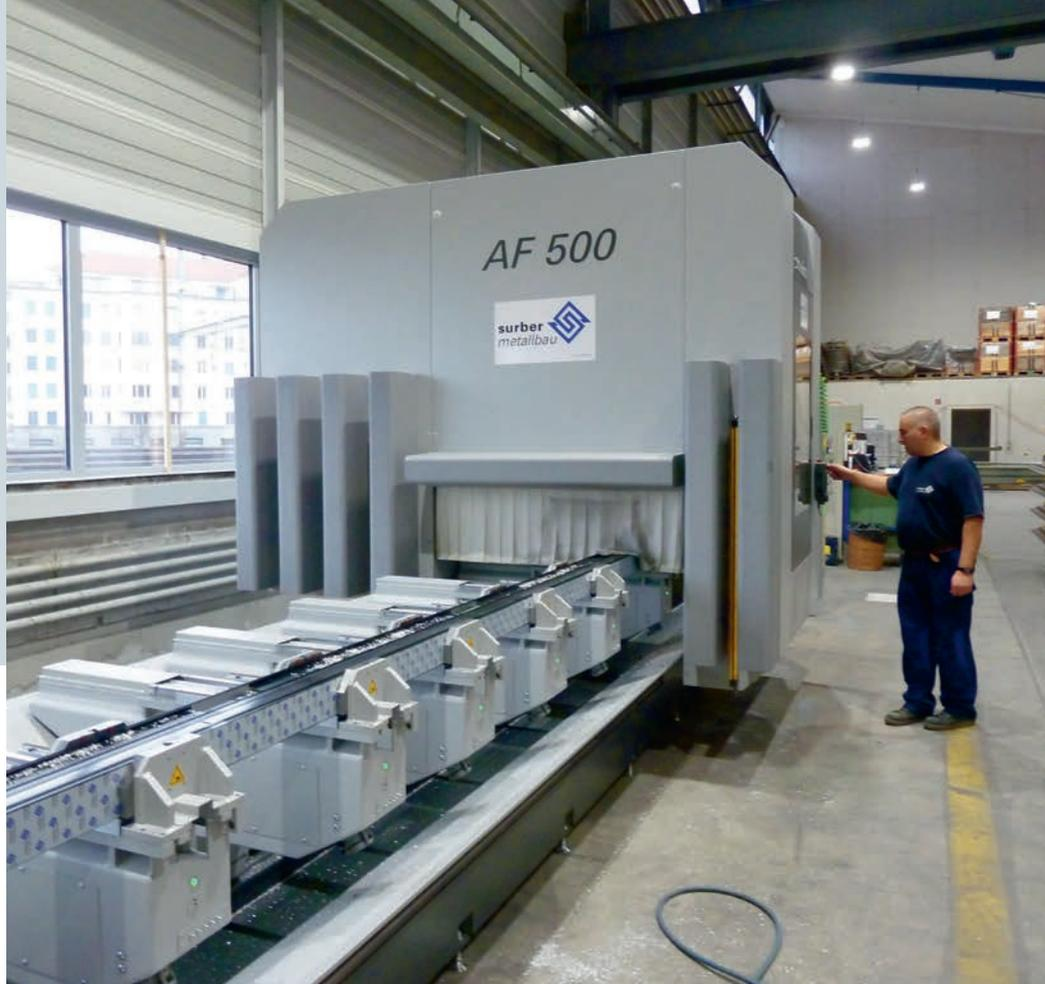
Profile für Fenster, Türen und Fassaden werden im Werk der Surber Metallbau AG mit der Bearbeitungsmaschine AF 500 von Schüco bearbeitet.
