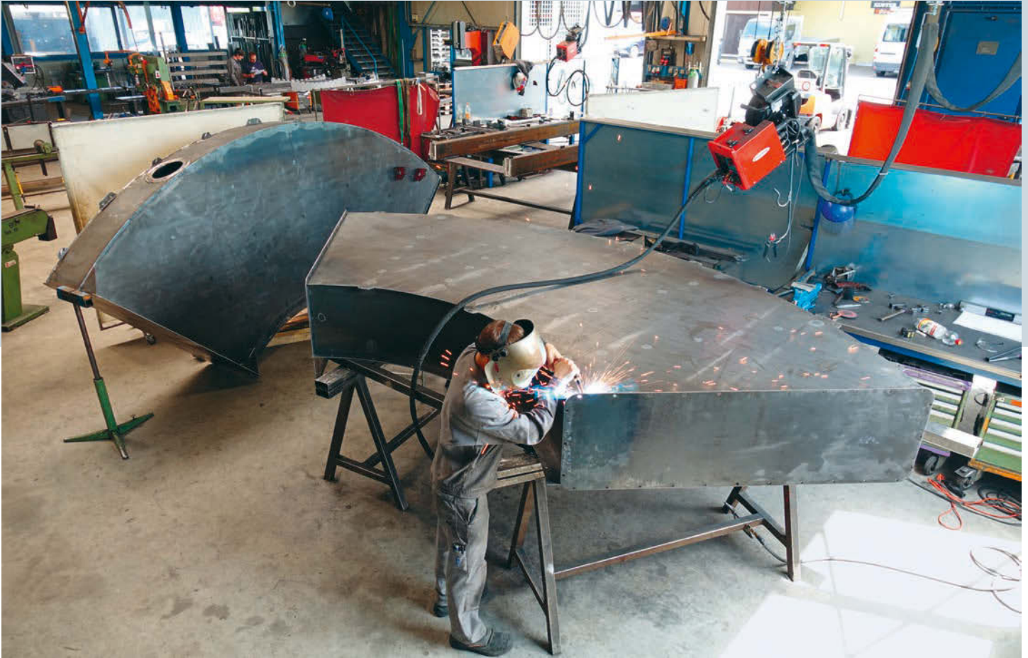
Die schwimmende Plattform besteht aus vier einzelnen Hohlkörpern. La plate-forme flottante se compose de quatre corps creux différents.
