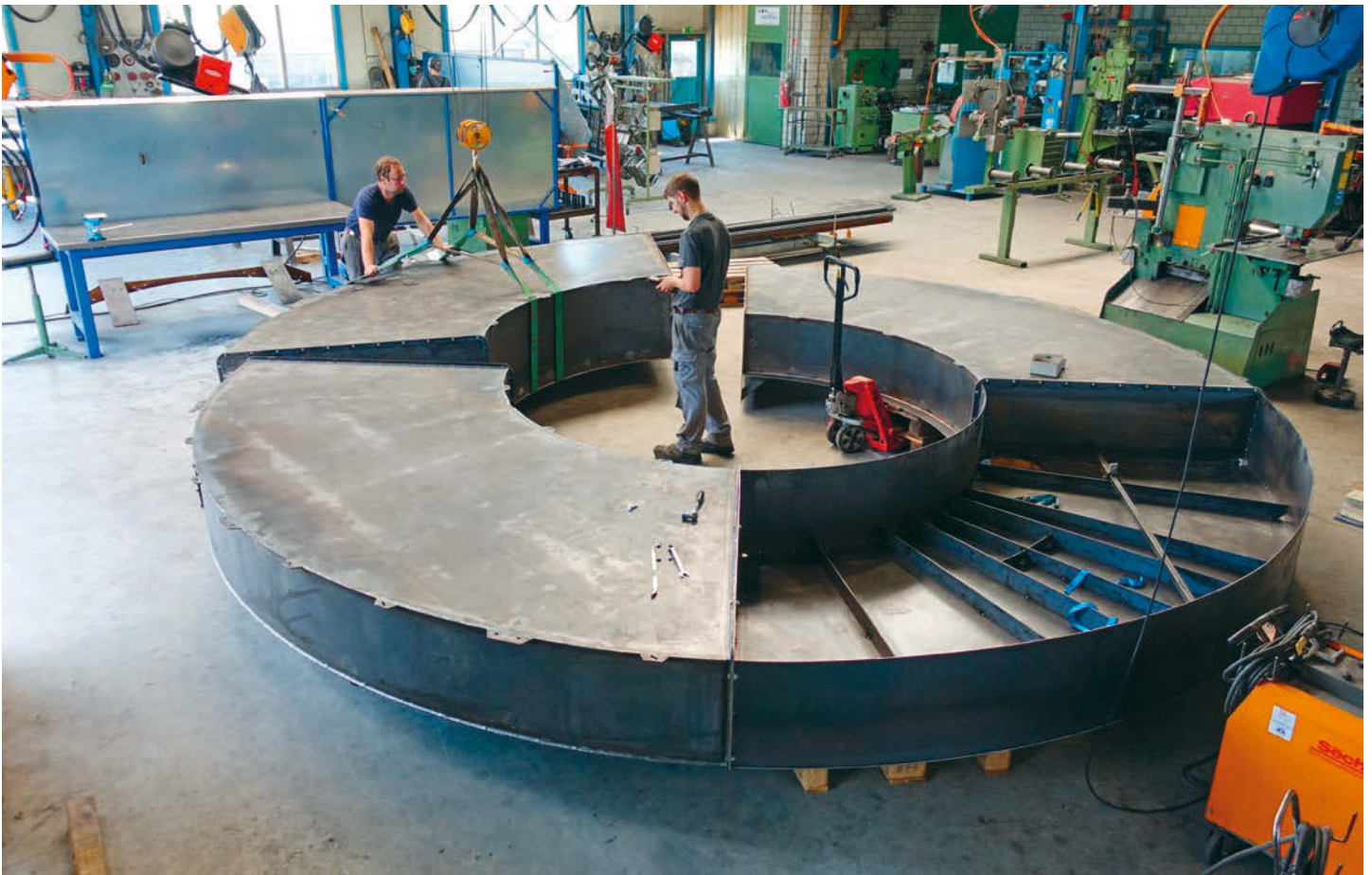
Die eingeschweissten Blechrippen gewähren Stabilität und Verzugsfreiheit. Les poutrelles en tôle soudées garantissent la stabilité et l'élasticité de la structure.
