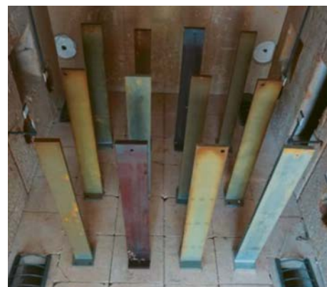
Vergleich der Proben vor (links) und nach (rechts) dem zweiten Brandversuch. ■ Comparaison des échantillons avant (à gauche) et après (à droite) le second test d'incendie
