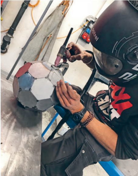
Zusammengesetzt aus vielen kleinen Blechteilen. Der «Floating Football» wird geschweisst. Soudage du Floating Football à partir de nombreux petits éléments en tôle.
