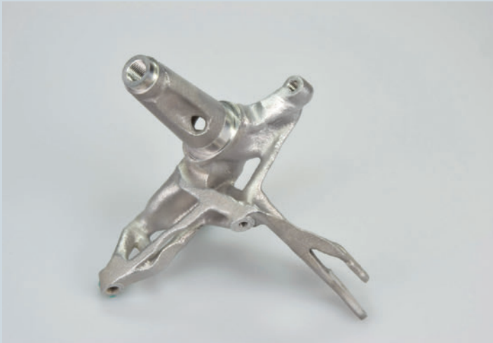
Strukturoptimierter Radträger eines Ultraleichtfahrzeugs: Design für Additive Manufacturing – Herstellung im 3D-Drucklabor Metall und Strukturwerkstoffe am Fraunhofer EMI.
