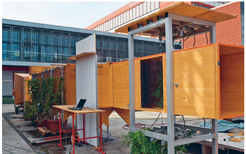
Abbildung 1: Turbulenter Windkanal an der HSLU T&A für die Windkraftuntersuchung an Pflanzen von bewachsenen Seilfassaden.
