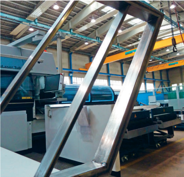
Geländerelement mit gesteckten und anschließend geschweissten Staketen. Élément de garde-corps fabriqué à partir de barreaux enfilés, puis soudés.
