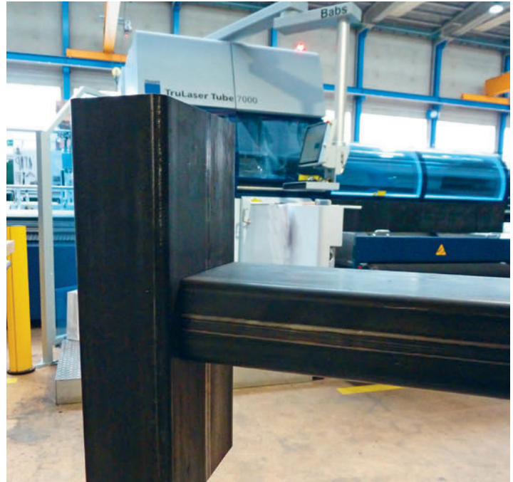
Eine gesteckte Rohrverbindung für Pfosten-Riegel-Konstruktionen ist zur Patentierung angemeldet. Une demande de brevet a été déposée pour des assemblages à poteaux et traverses par enfichage.
