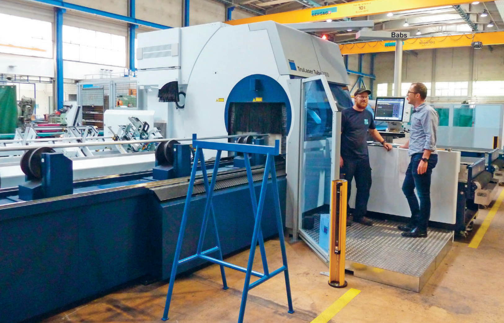
Die Laser-Rohrschneidmaschine an der Bearbeitung von Rundrohren. Matthias Ruch (rechts) erkundigt sich nach dem aktuellen Stand der Arbeiten. La machine de découpe de tubes au laser en train d'usiner des tubes ronds. Matthias Ruch (à droite) s'enquiert de l'état d'avancement des travaux.
