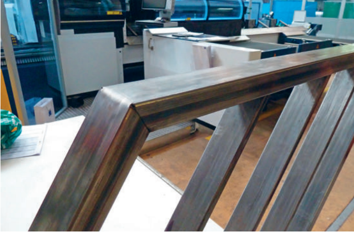
Rohrrahmenprofil am Stück ausgeschnitten und gebogen. Élément de garde-corps fabriqué à partir de barreaux enfilés, puis soudés.
