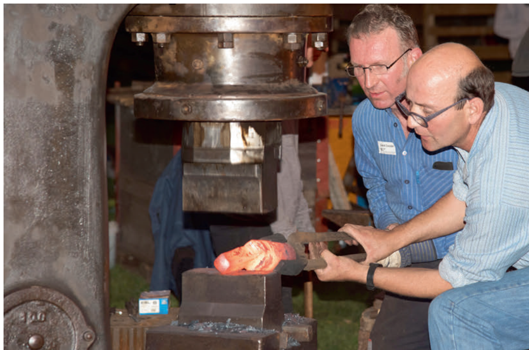
Grosses Stück unter dem Lufthammer.
