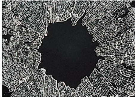
**Bild 8: Bruchbild Einscheiben-Sicherheitsglas (ESG).**
