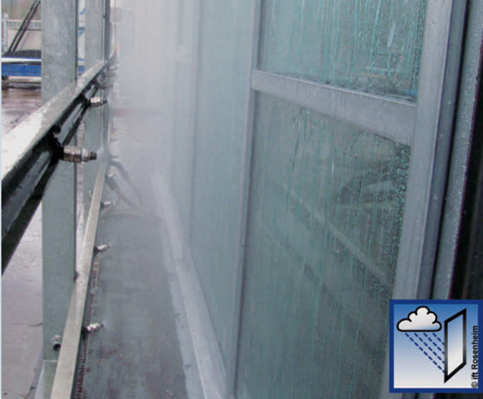
Bild 1: Prüfung der Luft- und Schlagregendichtheit sowie des Windwiderstands an einem Fassadenelement im ift-Prüflabor mit Dokumentation der Kennwerte im ift-Produktpass.
