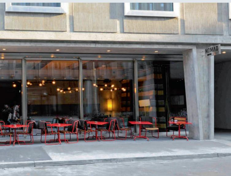
Schiebe-Fronten, Festteilen und einer Drehflügeltür. Alles ist aus geschliffenem, in exterieure du restaurant se compose de façades levantes-coulissantes, d'éléments en l'inox brossé à séparation thermique.
