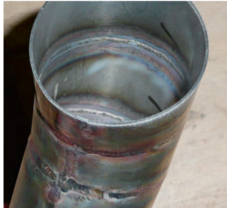
Ohne Formiergas geschweisst: verschiedene Anlauffarben innen und aussen.
