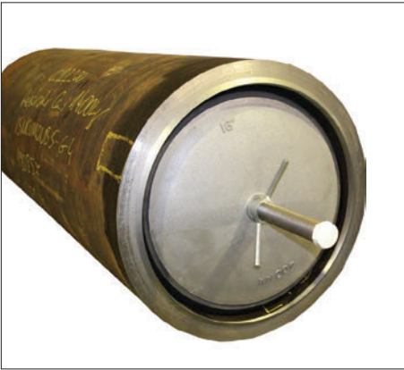
Die Abdichtung verhindert den Austritt des Formiergases.
