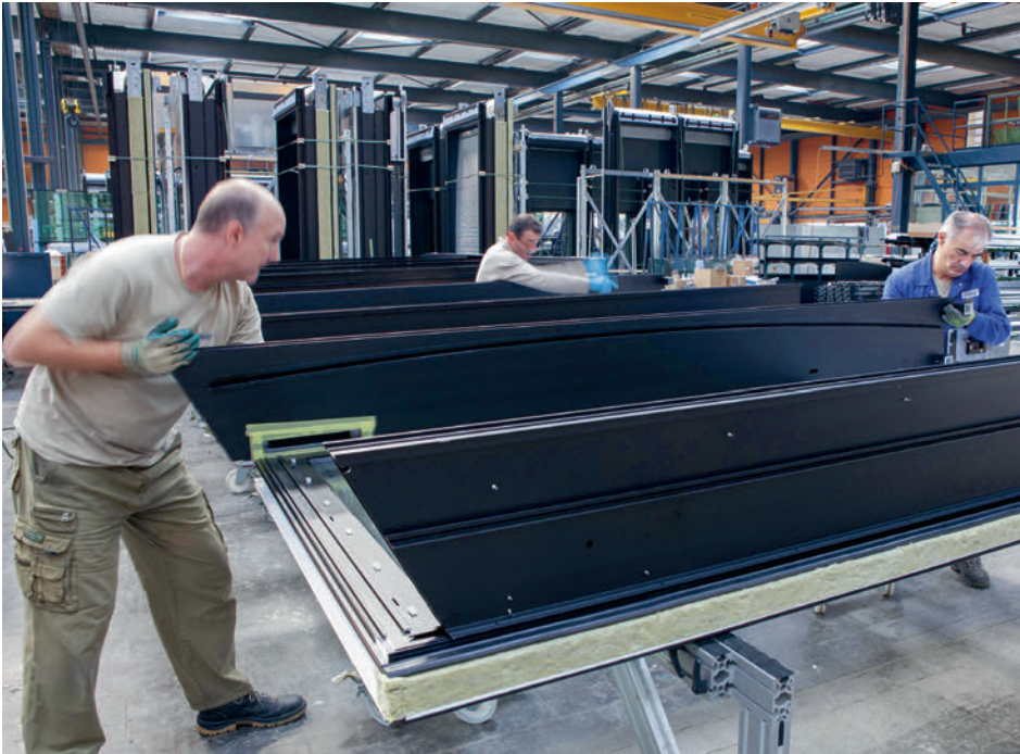
Beim Einsetzen der vertikalen Lisenenprofile mit den gewölbten Storenführungsnuten. Pose des profilés verticaux de type lésènes munis de rainures courbées de guidage des stores.
