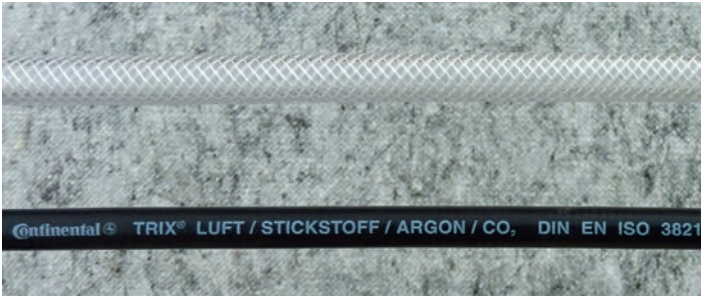
Abbildung 3: Ungeeigneter Druckluftschlauch (oben), Schlauch nach ISO 3821 (unten).
