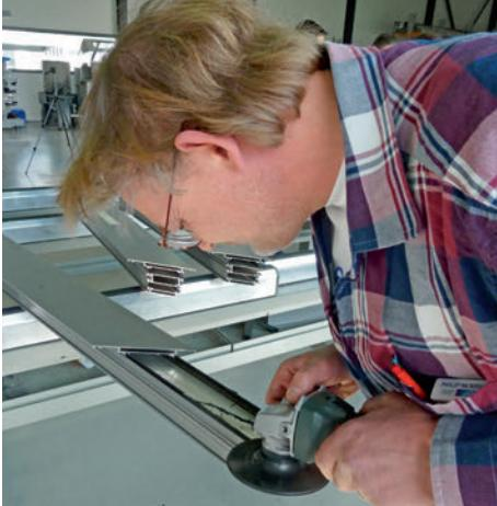
Ein vorbereitender Feinschliff im Sockelbereich. Gut zu erkennen die hochgeschobene, frei schiebbare Aluminium-Aussenschale. Sie reduziert den Bimetall-Effekt auf ein Minimum. Préparation du profilé dans la zone du socle. La coque extérieure en aluminium déplaçable relevée est facilement reconnaissable. Elle réduit l'effet bimétal à un minimum.
