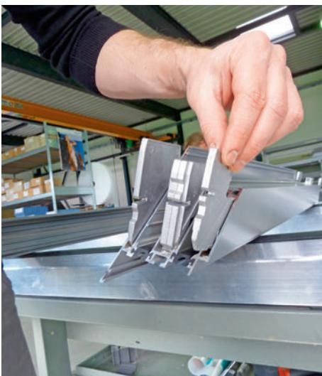
Einfaches Einführen der drei Eckverbinder in die Aluminiumkammern.
