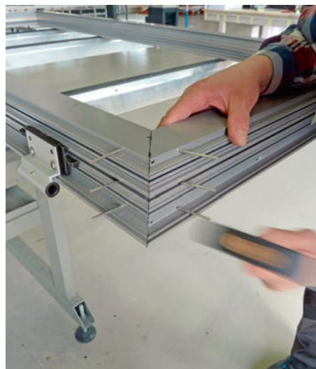
Die rund 60 mm langen, gekerbten Sicherungsstifte werden eingeschlagen und anschliessend mit dem Hammer oder von Hand abgebrochen und beseitigt. Les goupilles de sécurité entailées d'env. 60 mm de longueur doivent être enfoncées puis rompues avec un marteau ou à la main, les restes doivent être éliminés.
