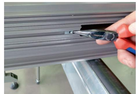
Die Nutenstein - versehen mit einem Gewinde - werden eingeführt. Sie dienen der rationellen Befestigung des Schlosses und des Schloss-Gegenkastens.
