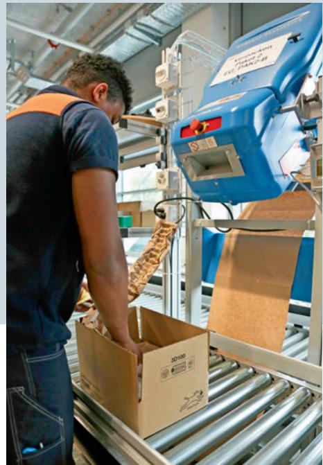
**Verpacken:** Die Versandetikette wird aufgeklebt und anschliessend erfolgt das automatische Kleben und Umreifen des Pakets. Emballage et rembourrage pour l'envoi. L'entrepôt à chambres très hautes pour petites pièces.
