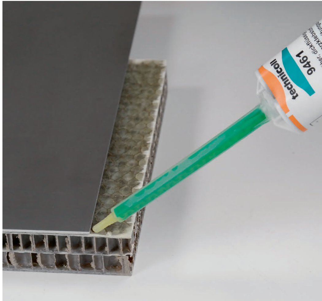
Verklebung von Metall mit Verbundwerkstoffen.
