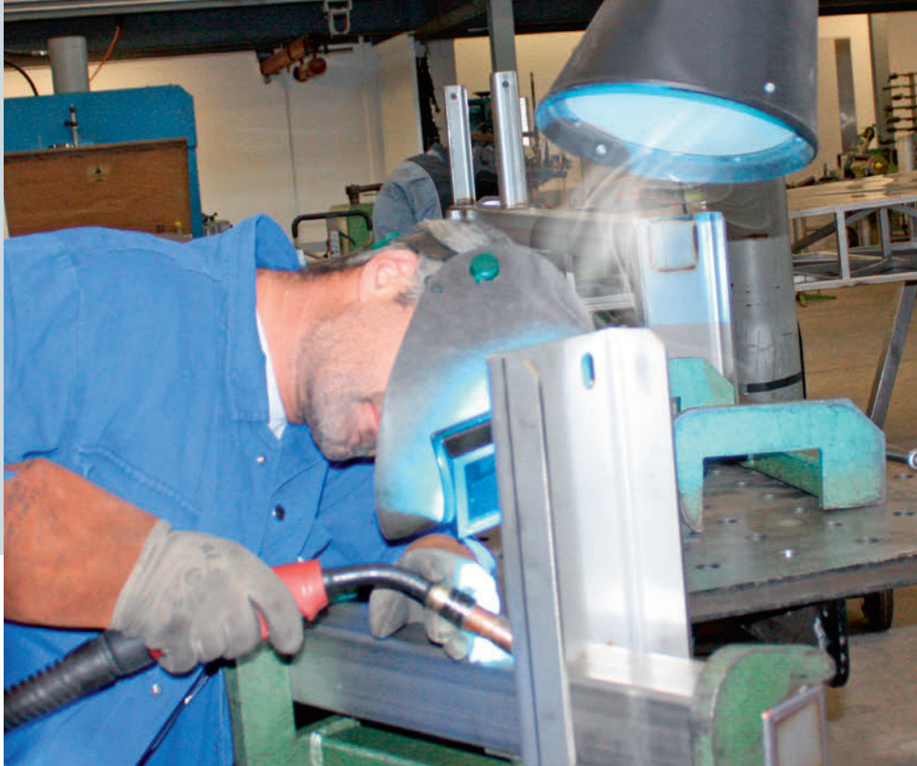
Schweisser sind optimal geschützt, da Absaugarme den Rauch direkt an der Entstehungsstelle aufnehmen.
