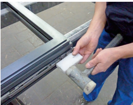
Ein schonungsvoller Hammerschlag genügt, um die Fensterschere zu fixieren.
