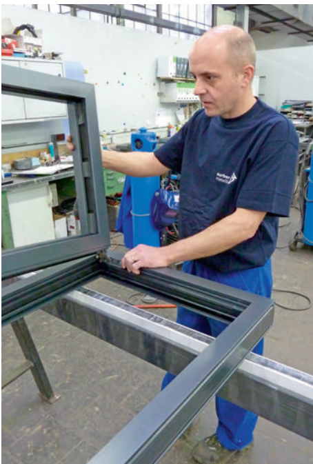
Einfacher Flügeleinbau: Der Fensterflügel wird unten in die bandseitige Rahmenecke gesetzt.
