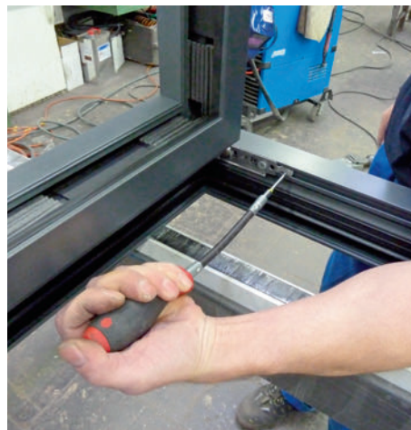
Die Flügel-Fixierung erfolgt über Drehnutsteine. Anschliessend Riegelstück einschieben, Flügel schliessen, Griff betätigen. Der Flügel richtet sich selber aus.
