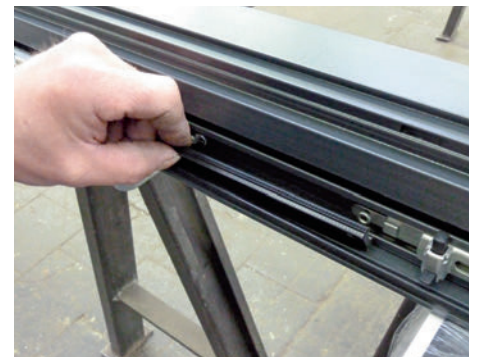
Die Schubstange aus glasfaserverstärktem Kunststoff wird eingesetzt. Bei erhöhter Einbruchssicherheit (RC3) kommt eine Hybrid-Riegelstange im Alu-Design zur Anwendung.
