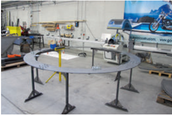
Aussenwand des Mühlrads und Montage der Bauteile. Fascia esterna inferiore della ruota del mulino e assemblaggio di diversi elementi.
