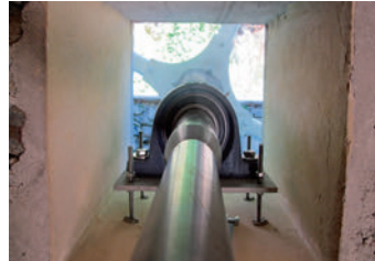
Blick aus dem Inneren der Mühle. Detailaufnahme der Kugellagerstützen. Vista dall'interno del mulino. Dettaglio del supporto dei cuscinetti.
