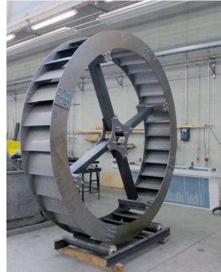
Das Rad sitzt auf einem von den Lernenden entworfenen und konstruierten Unterbau, der das Drehen erleichtert.
