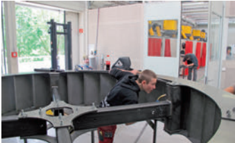
Heftschweissen des Mühlrads. Imbastitura della ruota
