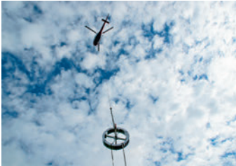
Hubschraubertransport: Das Rad wurde mit Seilen für den Lufttransport von Cadenazzo (Region Sassetli) zur Mühle gesichert.
