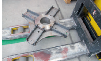
Radnabe, hergestellt von Lernenden der SMU und des CAM. Mozzo centrale della ruota del mulino realizzato grazie alla collaborazione tra apprendisti USM e CAM.
