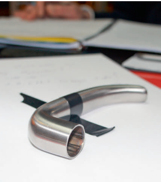
Bild 4: Abgebrochener Drücker. Photo 4 : Poignée cassée
