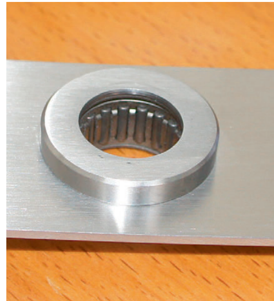
Bild 6: Drückerrossette mit Nadellager. Photo 6 : Rosette de poignée avec roulement à aiguille
