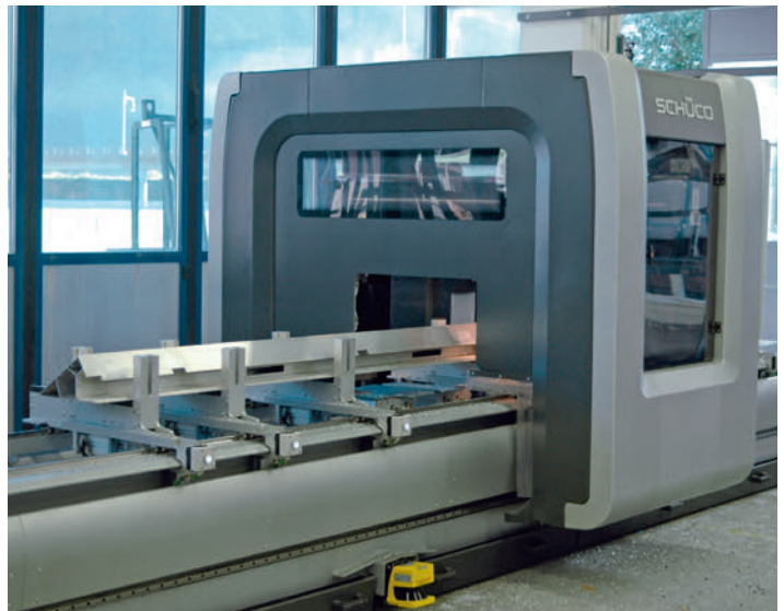
Das neue Bearbeitungscenter in Aktion. Auch grössere Profilquerschnitte lassen sich bestens bearbeiten.
