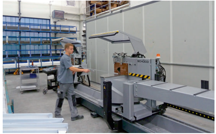
Die neue Doppelgehrungssäge ermöglicht dreidimensionales Zuschneiden an beiden Enden gleichzeitig.
