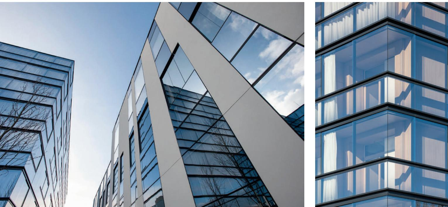
Die sog. Structural-Sealant-Glazing-Fassaden (SSG) im Langzeit-Beatmungszentrum sind mit der dahinter liegenden Tragkonstruktion, die nahezu unsichtbar ist, verklebt.
