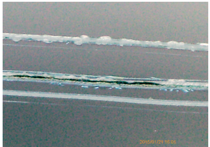
Abbildung 4: Kratzer schwerer Intensität, weisslich mit Absplittungen. Illustration 4 : Rayures profondes, blanchâtres avec éclats.
