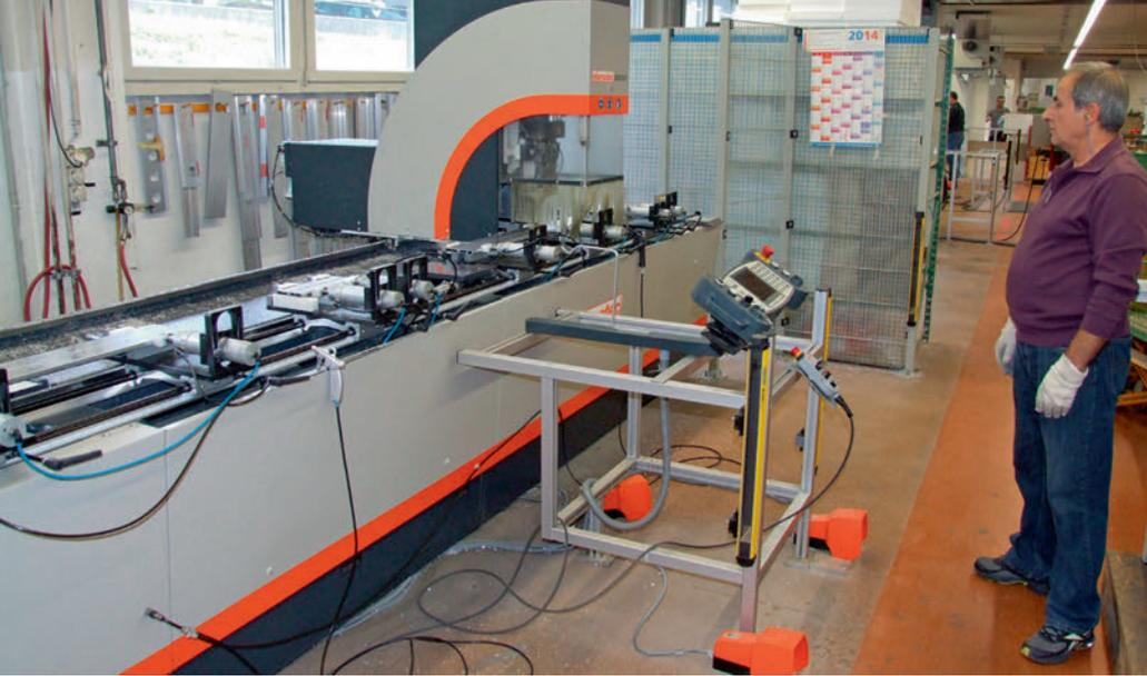
Mit der 3-Achs-Maschine SBZ 122 ist mit Winkelkopf auch die mehrseitige Profilbearbeitung am ruhenden Profil möglich.
