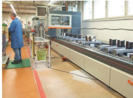
Das SBZ 140 im Einsatz: Das 4-Achs-Stubbearbeitungszentrum ist für die rationelle Bearbeitung von Aluminium- und Stahlprofilen konzipiert.
