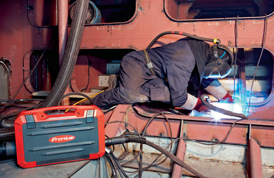
Das Drahtvorschubgerät VR 5000 Case von Fronius. Schweißer können damit auch an unzugänglichen Stellen und unter widrigsten Umgebungsbedingungen arbeiten.
