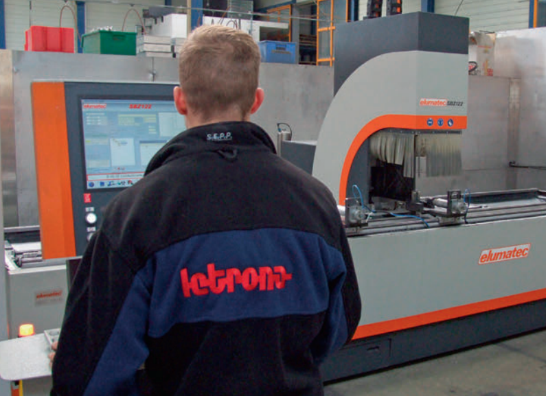
Das elumatec-Stabbearbeitungszentrum SBZ 122 im Einsatz.
