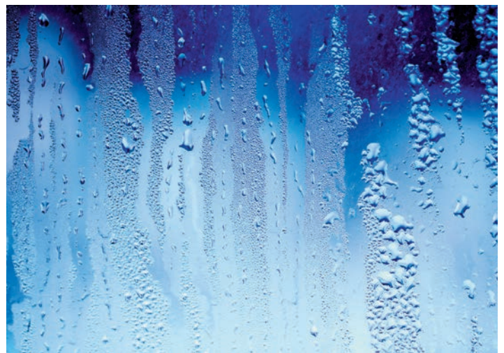
Da an gewissen Stellen eine andere Oberflächenenergie herrscht, führt dies zu einer unterschiedlichen Benetzbarkeit. Certains points affichant une énergie de surface distincte, on observe une mouillabilité différente.
