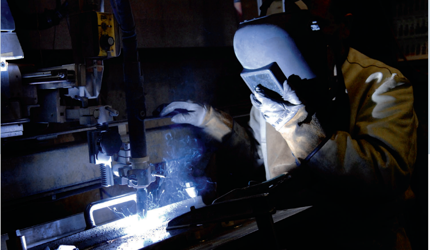
MIG-Schweissen von Aluminium auf einer Längsschweissanlage. Soudage MIG d'aluminium sur une installation de soudage en longueur.
