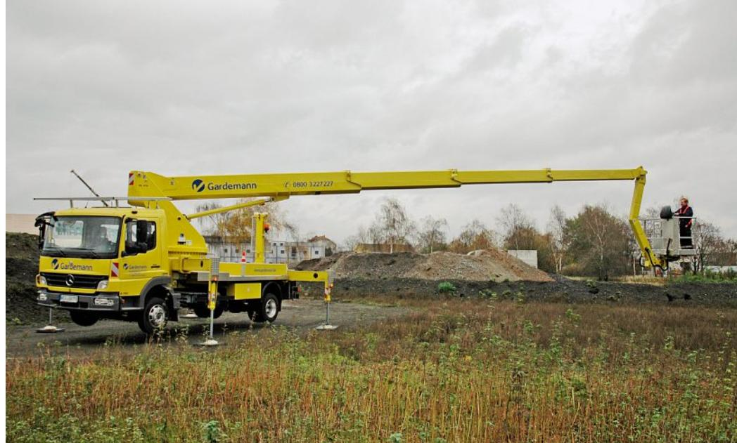
Testen Sie Ihre Standsicherheit, indem Sie mit möglichst waagerechtem Ausleger und nicht angehobenem Korbarm in geringer Höhe quer zum Lkw schwenken und so weit wie möglich austelekopieren. Testez la sécurité de votre stabilisation en orientant l'élévateur le plus horizontalement possible, sans relever le bras, à faible hauteur et perpendiculairement au véhicule, puis en le déployant le plus loin possible
