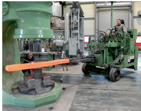
Das Rundprofil wird flach und kantig geschmiedet. Le profilé rond est forgé pour être aplati et recevoir sa forme carrée.
