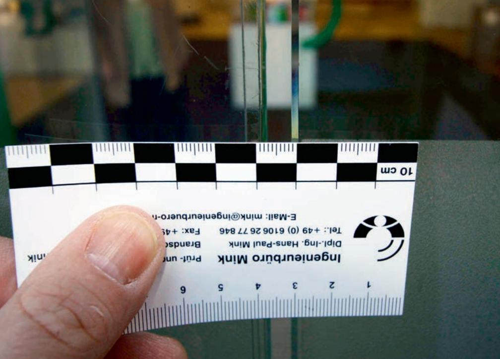
Der Spalt zwischen den Flügeln lag mit etwa sechs Millimetern unter dem maximal zulässigen Spaltmass von acht Millimetern und war nicht zu beanstanden. Schadensursache war die zu kurze Schliesszeit und die hohe kinetische Energie.
