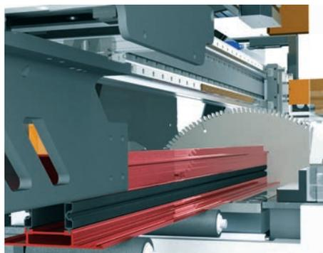
Kraftvolle Säge für Aluminium- und PVC-Profile. Die SBZ-616-Variante «Vario» erlaubt zusätzlich stufenlos einstellbare Schnittwinkel von 22,5° bis 157,5°.
