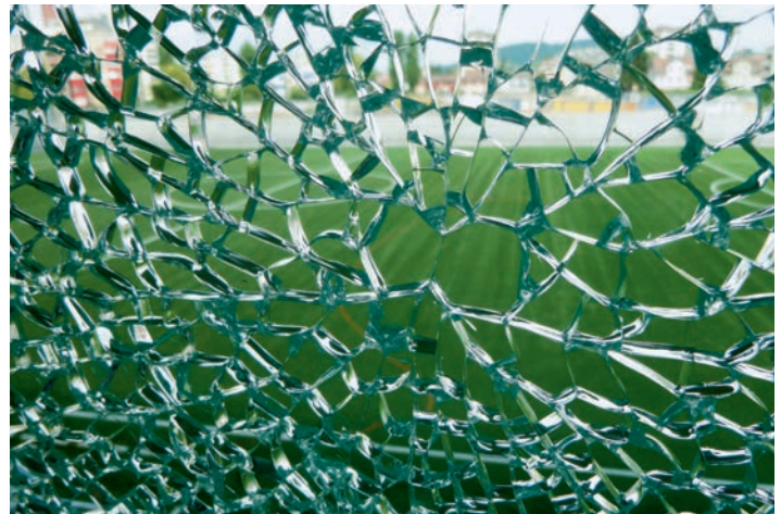
VSG-Einheit aus ESG mit klassischen Schmetterlingsflügeln. Verre feuilleté (VSG) en ESG avec ailes de papillon classiques.
