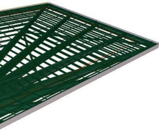
**20 sternförmig angeordnete Kragträger in unterschiedlichen Längen bilden die Primärkonstruktion.**
