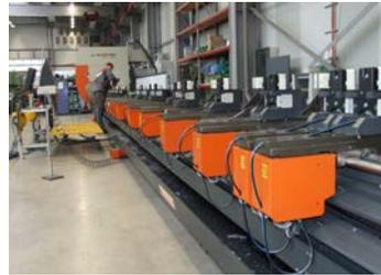
Die SBZ 151 hat 20 Spanner, die autonom verfahren können, während die Spindel bearbeitet. Effekt: grosse Flexibilität und hoher Materialdurchsatz.
