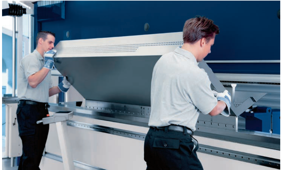
Die Rückfederung muss beim Biegen besonders bei stark federnden Materialien genau berücksichtigt werden. Le retour élastique doit être surveillé de près, notamment lors du pliage de matériaux fortement élastiques.
