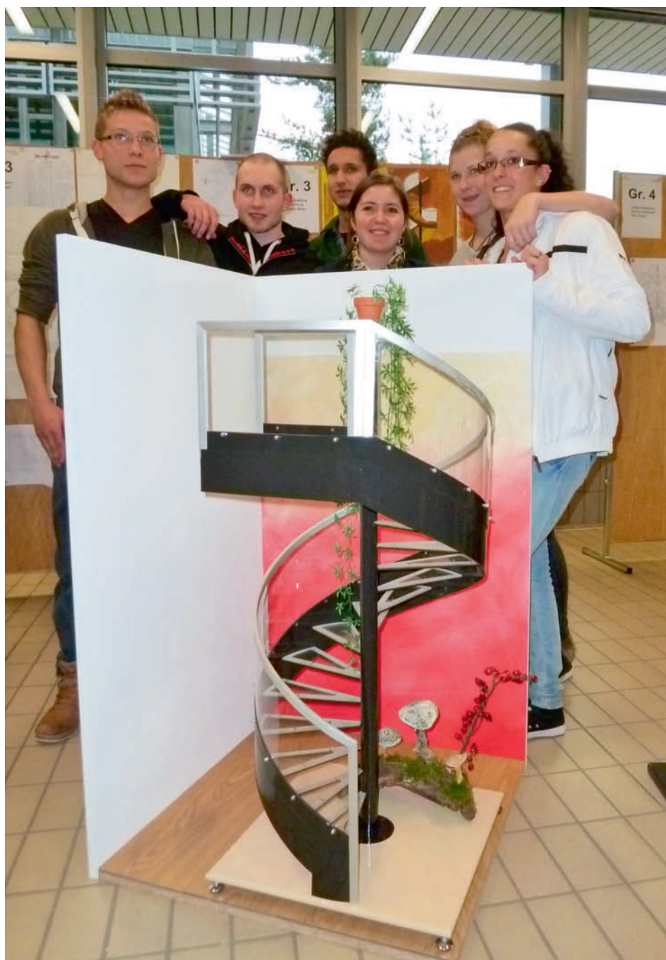
Beeindruckende Spindeltreppe mit Aussenwange. Das Geländerglas ist im warmen Zustand gebogen worden. Die Glasstufen sind - von den Lernenden selbst - sandgestrahlt worden.
