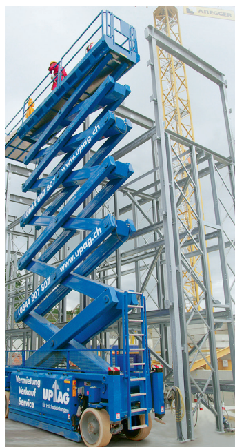
S 320-12 Im Hochregallagerbau sind diese Geräte mit bis zu 32 Metern Arbeitshöhe nicht mehr wegzudenken.
