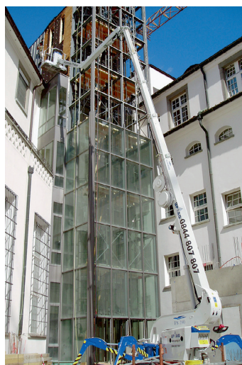
FS 290 Falcon Spider Erreicht eine Arbeitshöhe von 29 Metern.
