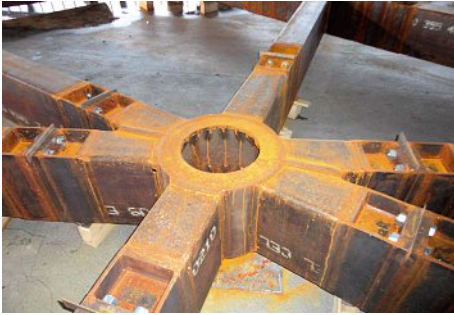
Kreuzpunkt mit Nabe für den Stützenkopf. Point de croisement avec moyeu pour la tête de support.
