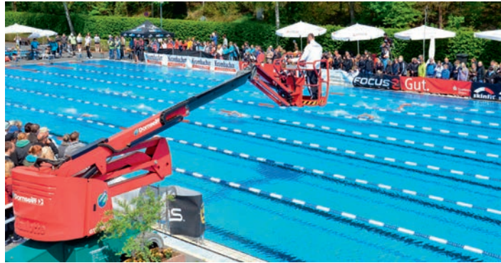
Mit der selbstfahrenden Gelenkteleskopbühne GTB 150E konnte der Arbeitsbühnenkorb bis zur Mitte des Schwimmbeckens ausgefahren werden.
